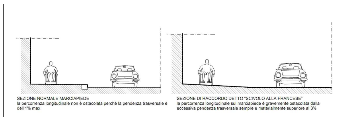
Figura 5 Pendenza trasversale massima ammissibile marciapiede
